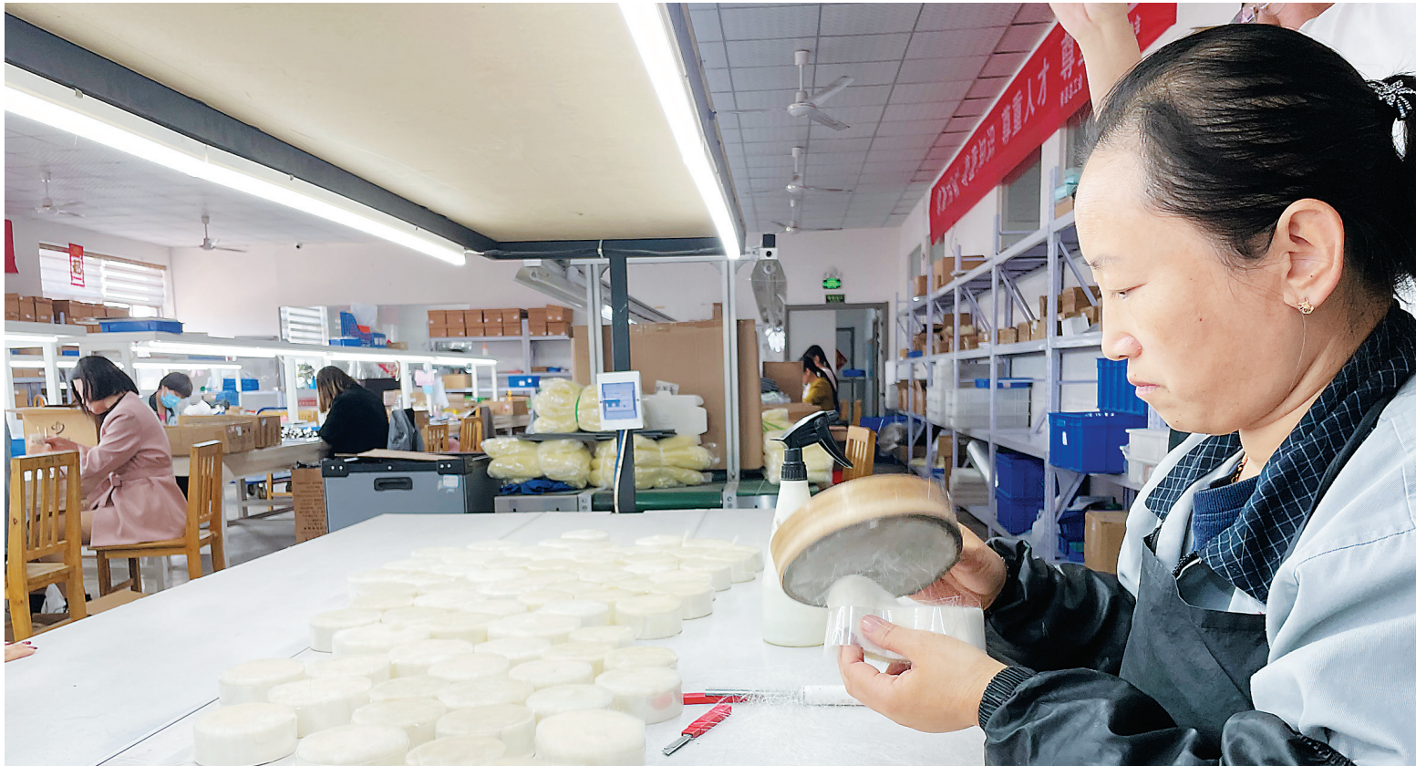
工人正在利用密网筛出毛中的倒根
